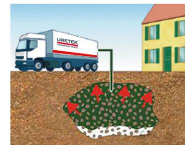
La résine est injectée sous une forme fluide au travers de tubes d'injection. Si la cavité n'est pas accessible, les tubes sont disposés dans des forages entre la surface et la cavité. Si la cavité est accessible, les tubes sont prépositionnés avant tous travaux de comblement. La résine se dilate et durcit par réaction chimique de polymérisation pour produire, du fait de son expansion, la saturation de la cavité et un compactage du matériau de comblement ci-avant.
