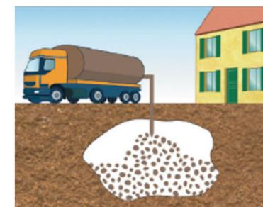
Si la cavité n'est pas accessible, le remplissage s'effectue de manière gravitaire au travers de forages depuis la surface. Si la cavité est accessible, le remplissage s'effectue par soufflage directionnel depuis l'intérieur de la cavité.
