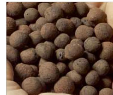
Le produit se présente sous la forme de billes légères de granulométrie 4/10 mm. Ces billes sont obtenues après cuisson et expansion de bâtonnets d'argile dans un four rotatif dont la température atteint 1100 degrés. L'argile y est pétrie et malaxée avant d'être extrudée en forme de petites billes rondes.
